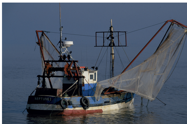
Photo 31 – Pibalour en Gironde. On remarquera les patins à la base inférieure des cadres qui permettent au tamis de glisser sur les zones de vase lorsque la profondeur est faible. (copyright Ifremer)
